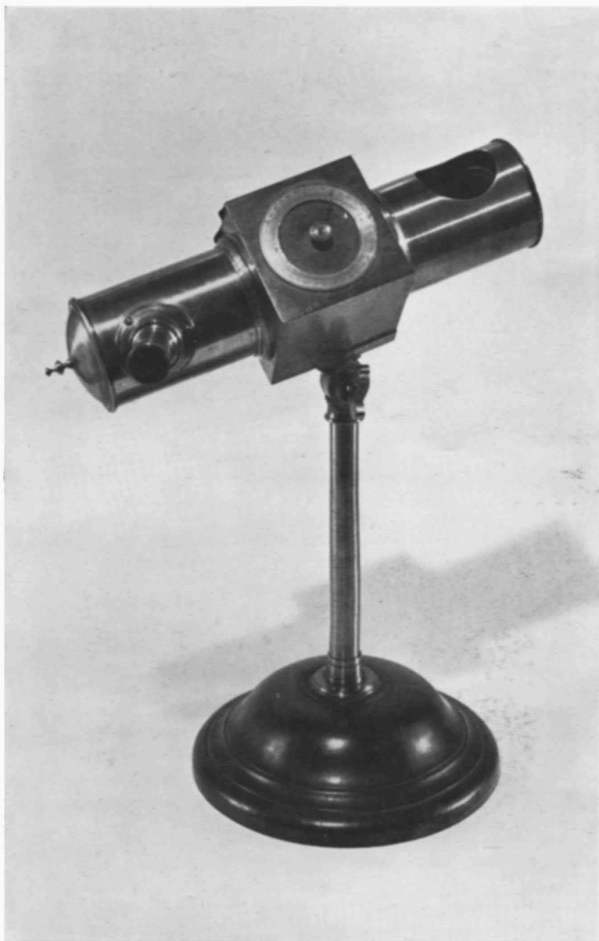
Fig. 5. Kleurenmeter van Van Beek. Aan de beide uiteinden der buis zitten spiegels, die resp. als polarisator (rechts) en analysator (links) dienst doen; in het midden wordt het te onderzoeken kristal geplaatst. De hoek, waaronder men dit draaien moet om een bepaalde kleur te kunnen waarnemen, kan op de in het midden zichtbare schaalverdeling afgelezen worden.
