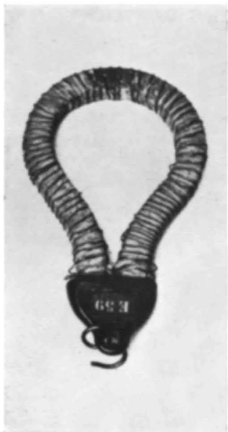
Fig. 1. Een door Van Beek in 1823 geconstrueerde electro-magneet.
