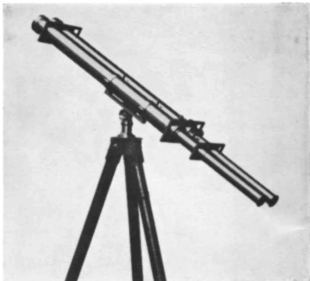
Fig. 2. Binoculaire kijker van Dollond, gebruikt bij de proeven ter bepaling van de geluidssnelheid, 1823.
