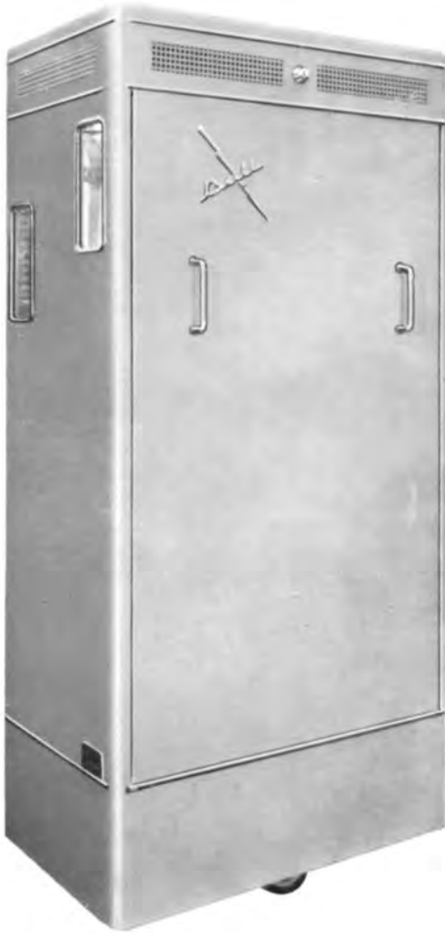
Photo-lecteur. Leest automatisch tekens die met de hand in een bepaalde voorbedrukte indeling op een ponskaart zijn geschreven. De aldus gelezen gegevens worden geponst door de reproducerende ponsmachine PRD.
