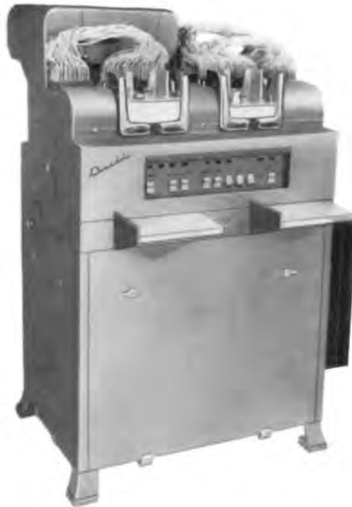
Reproducerende ponsmachine PRD (Poinçonneuse, Reproductrice, Duplicatrice). Voor het reproduceren van gegevens van een kaart in een andere kaart, het dupliceren van bestaande kaarten of het in serie ponsen van gegevens die uit een moederkaart worden gelezen. Het programma der werkzaamheden wordt vastgelegd in verwisselbare schakelborden.
