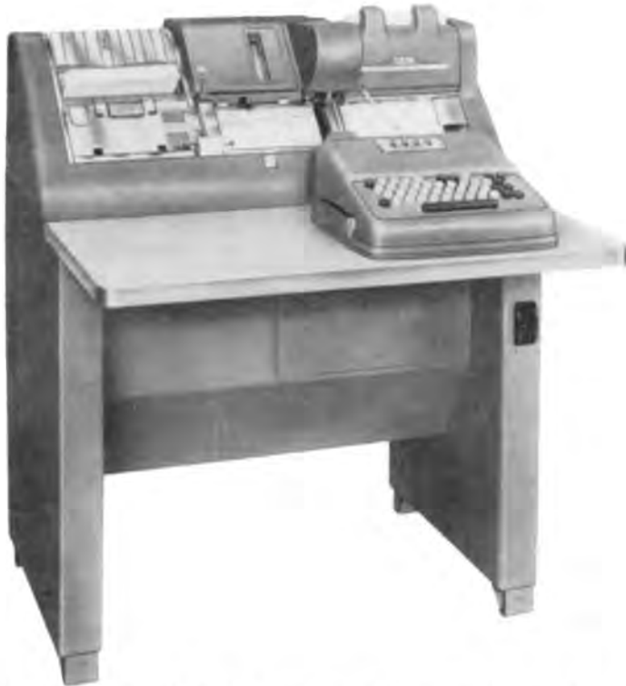
Schrijvende ponsmachine (Printing card punch) 026. Combineert het ponsen van de gegevens in de ponskaart met het gelijktijdig vertolken ervan aan de bovenrand van de kaart, en wel direct boven het geponste gaatje. De 026 werkt met 1 ponsing per cijfer (10), 2 ponsingen per letter (26) en 3 ponsingen voor speciale tekens (11) (totaal 47 tekens).
