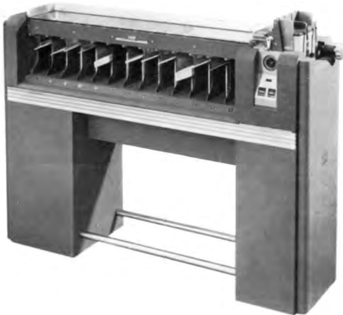
Sorteermachine (Sorter) 082. Rangschikt automatisch de ponskaarten in numerieke alfabetische of alfanumerieke volgorde. Bij het alfabetisch sorteren zijn twee werkingsgangen per kolom noodzakelijk, aangezien een letter door twee ponsingen in één kolom wordt voorgesteld.
