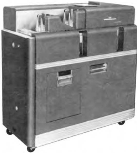
Endprinting Reproducer 519. Reproduceert bestaande kaartstellen en voorziet allerlei kaarten van een in grote cijfers vertolkte nummering op de linkerhelft van de ponskaart.
