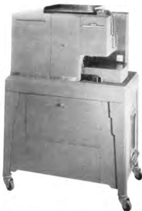
Alfabetische Vertolker (Card interpreter) 552. Drukt de in de kaarten geponste gegevens in leesbaar schrift op de ponskaarten af, echter met een lettertype dat groter is dan dat van de schrijvende ponsmachine 026, zodat, in plaats van 80, slechts 60 kolommen op één regel kunnen worden vertolkt.
