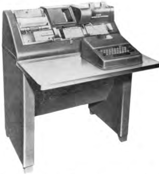
Cardatype Schrijvende Ponsmachine (Printing card punch) 536. Deze schrijvende ponsmachine, verbonden met de controle-eenheid 858, pons en vertolkt automatisch woordkaarten, op grond van de in de 858 ingevoerde tekstkaarten.
