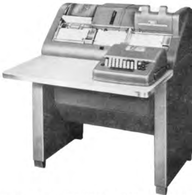
Controleponsmachine (Card verifier) 056. Door middel van toetsen die worden ingedrukt bij het een tweede keer aanslaan van de oorspronkelijke tekst, vergelijkt de controleponsmachine de oorspronkelijke gegevens met de reeds door de ponsmachine geponste gaatjes in de kaarten. Indien de ingedrukte toets geen geponst gaatje vindt, wordt de machine geblokkeerd.
